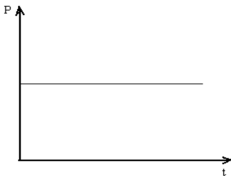
Рис. 3.1. Навантажувальна діаграма насосів і вентиляторів
