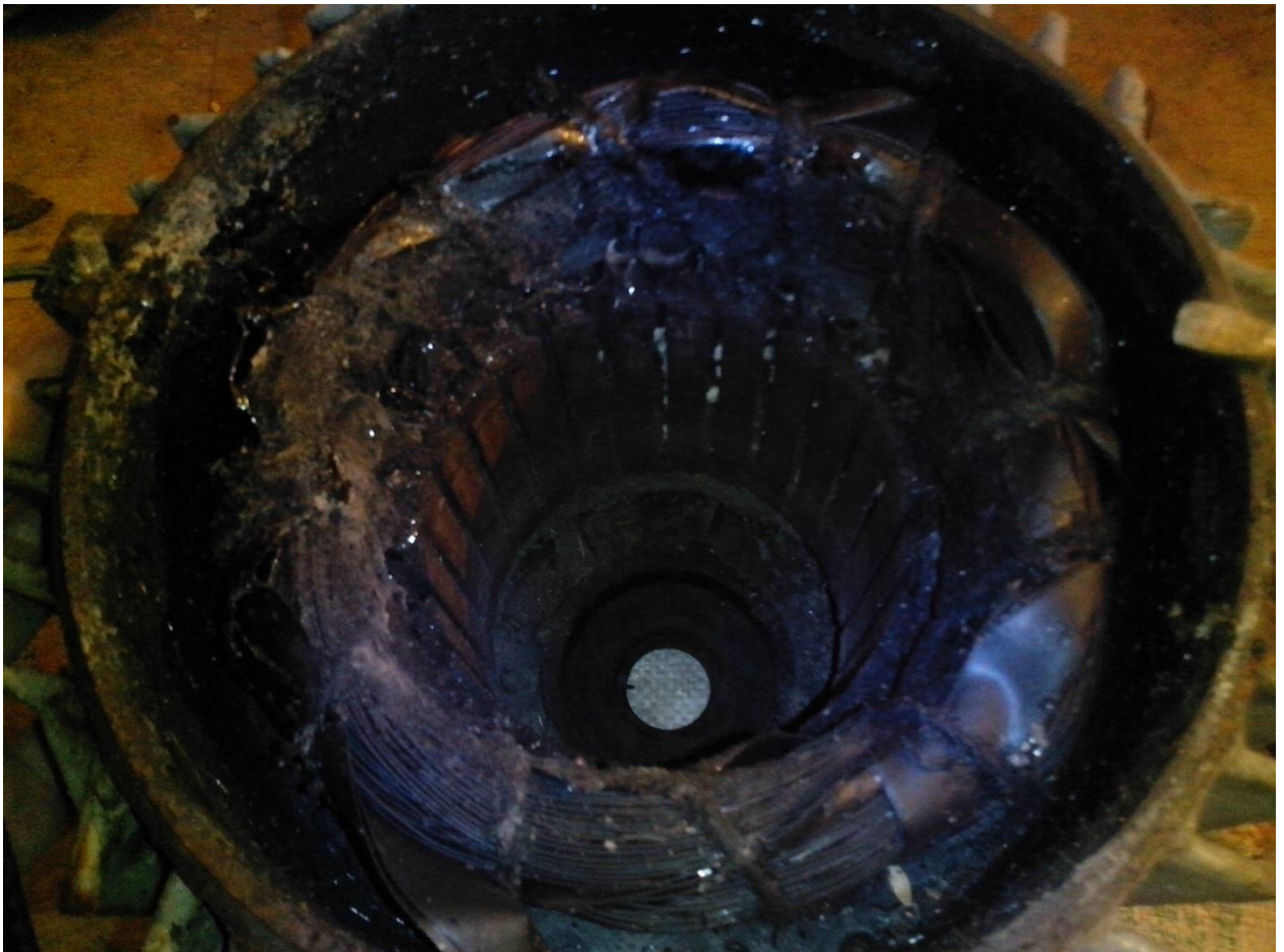
Огляд наслідків неправильного використання асинхронного двигуна з короткозамкненим ротором 4кВт 2900об/хв
